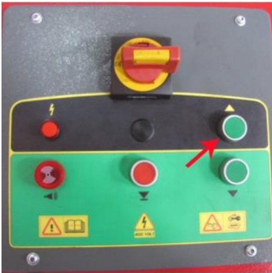
۳- فشاردادن دکمه بالابری و بردن جک به ماکزیمم ارتفاع
