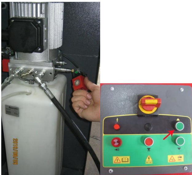
۸- فشردن دکمه بالابری و کنترل خارج شدن روغن خروجی
