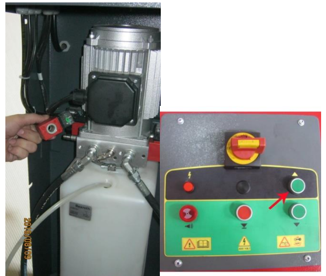
۵- فشردن دکمه بالابری و کنترل خارج شدن روغن خروجی از شلنگ هواگیری
