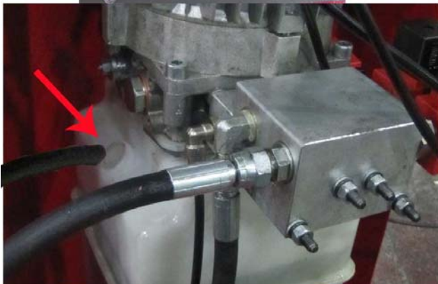
8- فشردن دکمه بالابری و کنترل خارج شدن روغن خروجی
