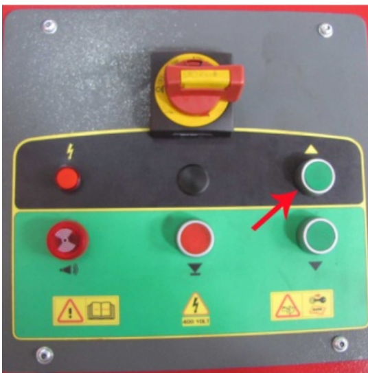
3- فشار دادن دکمه بالابری و بردن جک به ماکزیمم ارتفاع
